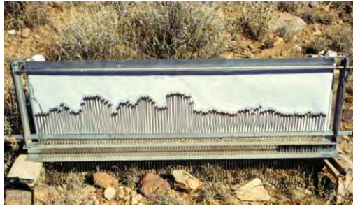
Fig. 4.19 Aparato de alumínio construído pelo Departamento de Agricultura dos Estados Unidos (USDA) para estimar rugosidade de um terreno ao longo de um perfil de um metro. Foto: E. E. Sano.
