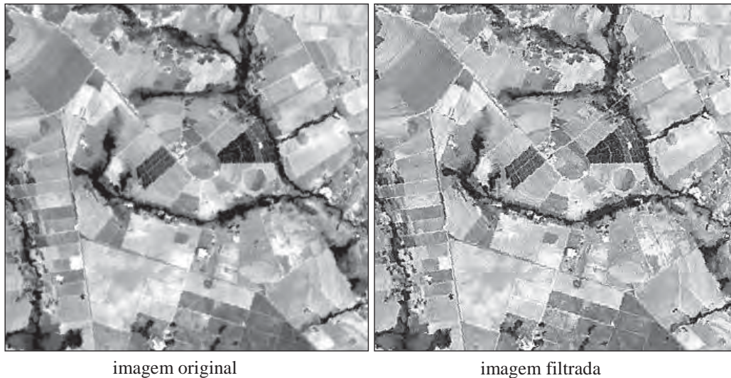
Fig. 11.5 Resultado da aplicação de um filtro passa-alta com fator de amplificação K=2 que realça os detalhes da imagem e preserva as baixas frequências, a fim de se ter uma imagem possível de interpretação visual temática.
