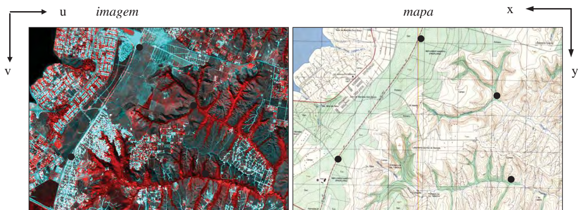
Fig. 6.11 Sistemas de coordenadas mapa-imagem para localização dos pontos de controle para o georreferenciamento da imagem.
