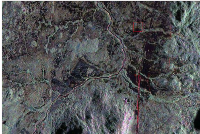
Fig. 4.22 Imagem de radar R99B aerotransportado (comprimento de onda de 23 cm, multipolarizada), mostrando as matas de galerias em tons de cinza claros devido à constante dielétrica alta da vegetação.
